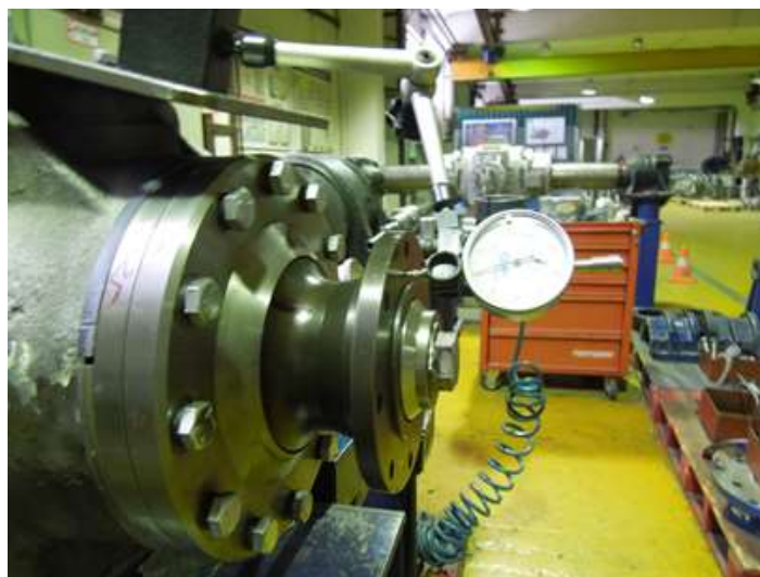
Рисунок 5.3.2.16 - Проверка торцевого биения буртика шлицевого фланца
