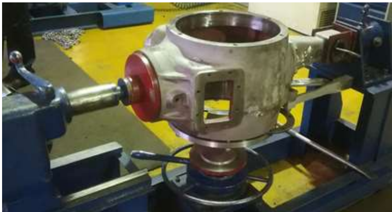
Рисунок 5.3.3.7 – Стенд для сборки редуктора
