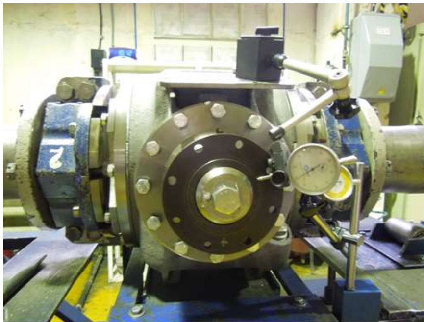
Рисунок 5.3.2.15 – Проверка радиального биения буртика шлицевого фланца
