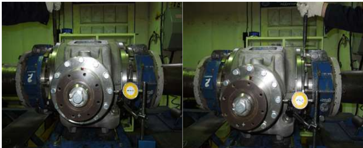
Рисунок 5.3.2.13 – Проверка осевого зазора в подшипниках полого вала.
