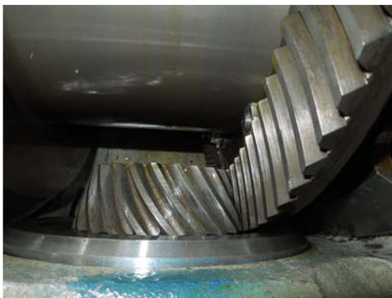
Рисунок 5.3.2.11 – Проверка пятна контакта
