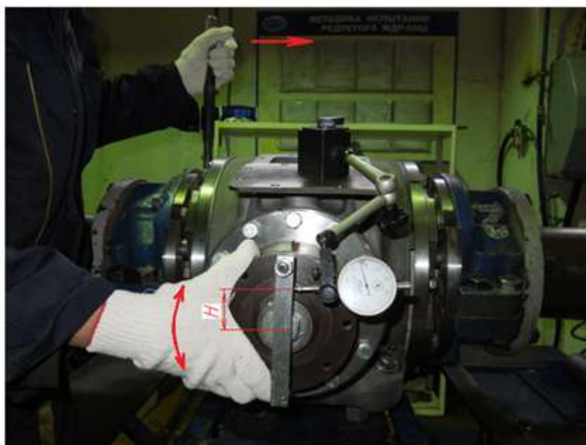
Рисунок 5.3.2.12 - Проверка зазора в зубчатом зацеплении
