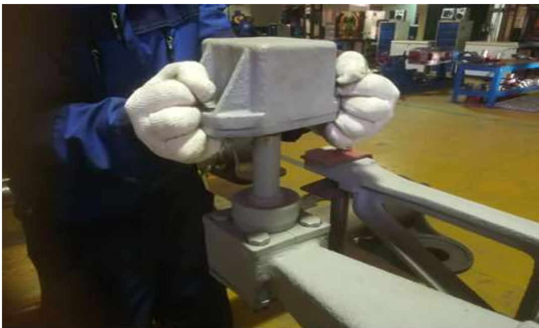
Рисунок 5.3.2.10 – Проверка опоры в резиновых амортизаторах
