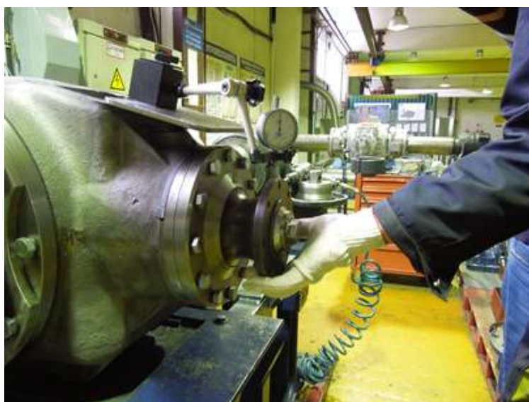
Рисунок 5.3.2.17 – Проверка радиального зазора в роликовом подшипнике узла ведомого вала
