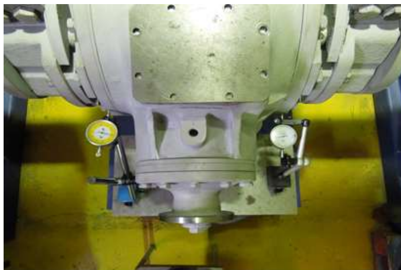
Рисунок 5.3.2.14- Проверка биения корпуса редуктора
