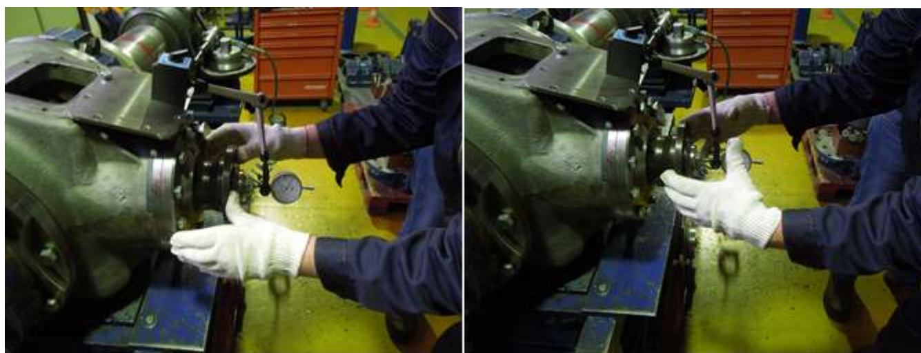
Рисунок 5.3.2.18 – Проверка осевого зазора в шариковом подшипнике узла ведомого вала
